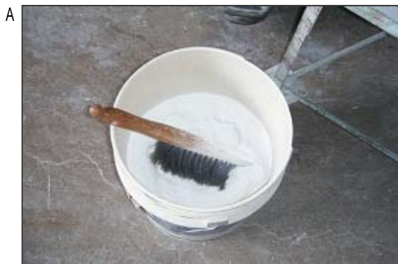
A タルク入りのバケツにハケが入っています。タルクにはしばしば石綿が不純物として混入していました。
