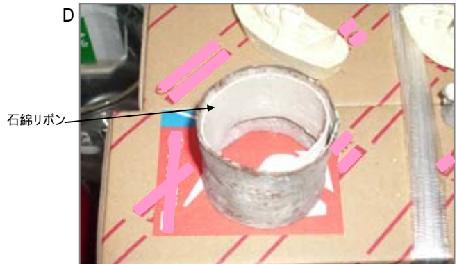
D リボンと型。筒にリボンが貼り付けられています。患者さんの歯から歯のつめもの型をとった後にこの筒(リング)に入れます。
