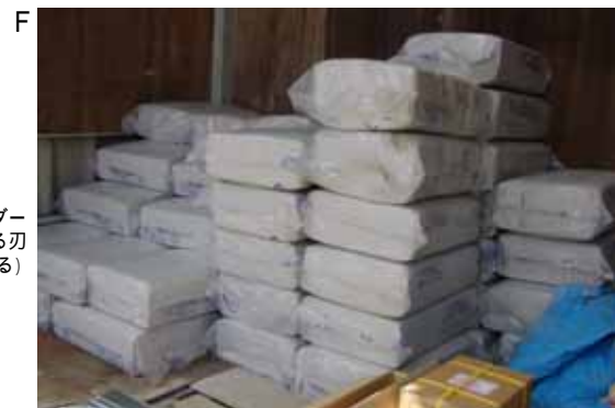
吹きつけ石綿用に工場で調合された梱包形態(ビニールで圧縮梱包されています)。昔の原綿輸入は麻袋や紙袋に入っており梱包が破れてばく露した、などのケースがありました。
