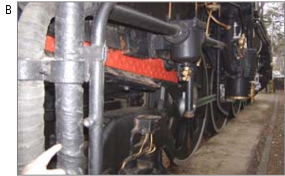
蒸気機関車はボイラー本体を積載しています。そのボイラー全周の断熱材や派生する配管には石綿テープが巻かれ、省エネ、運転室での乗務員のヤケド防止に有効です。
