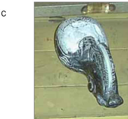
C タルクの入っている墨つぼ。通常は黒い墨を使用しますが、印をつける対象物が黒いものや鉄板などの場合にタルクを使用します。
