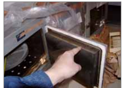
レンジ・オーブンなどの断熱材として使用
