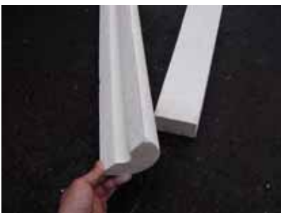
石綿保温材(けい酸カルシウム板)、耐火板など(白石綿)
