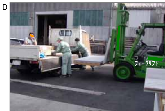
D 石綿含有ボードの出荷状況。多量時はフォークリフトを使用しますが少量の時は手積みします。スレート板に比べてけい酸カルシウム板の方がやや粉っぽいです。
