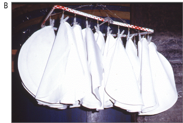
B 石綿を濾(こ)した後の布は洗って乾燥後再使用しました。乾いて円板状に固まった石綿はそのまま外に捨てていたとことで、その際に石綿繊維にばく露した可能性があります。
