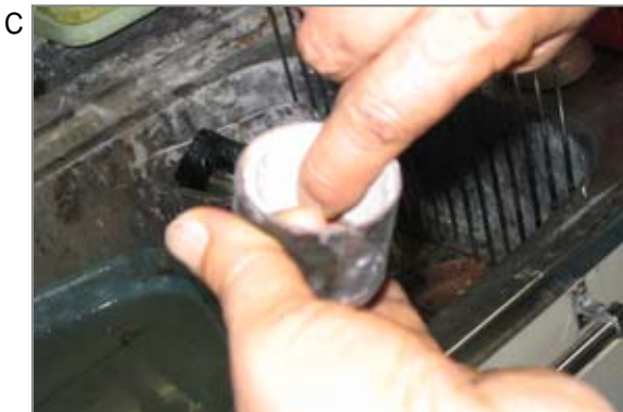
C 石綿リボン作業。歯科技工の作業では石綿リボンをよく使っていました。写真は歯のつめもの作成の際に使用する筒(リング)の内部に石綿リボンを貼り付けているところです。
