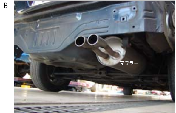
B 同じマフラーには、高熱になる排ガス熱の断熱目的で、断熱材を内張りしているものがありました。この他にクラッチフェーシング(駆動系に用いる摩擦材の一種)にも石綿が含有されていました。
