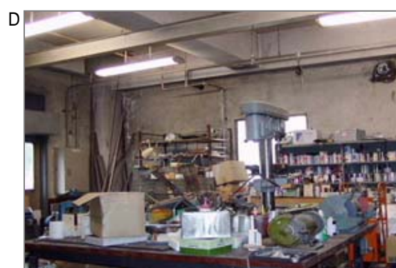
D 工具室。なんでも直せるように電動工具や小道具が揃っています。石綿糸や布もありましたが壁と天井に吹きつけられている青石綿のほうの影響は大きいと考えられます。
