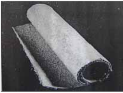
フェルト材(白石綿、青石綿)
