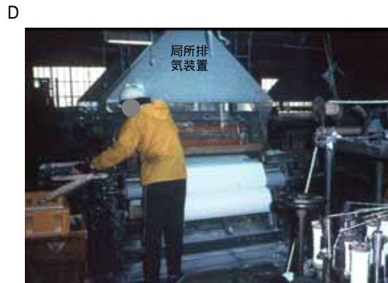
ローラーにかけ所定の厚みにしているところ。写真は石綿の飛散を防ぐため局所排気装置がつけられています。石綿布はタテ糸、ヨコ糸を背広などの生地製造と同じように織りました。
