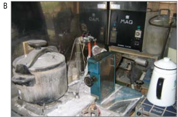
B 作業室イメージ。歯科技工の作業は歯科技工士だけではなく歯科医も行って来た作業です。石綿リボンの使用、電気炉での石綿使用などがあります。
