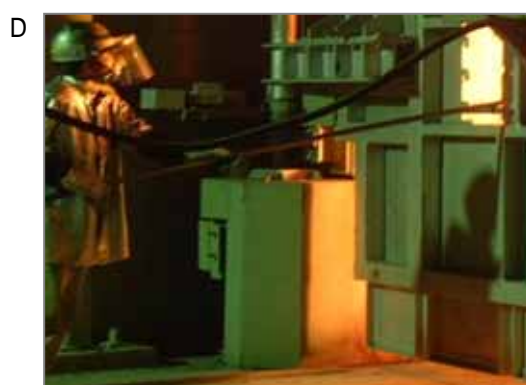
製鉄・製鋼の巨大な装置類は、炉内も含め全周石綿含有保温材で被覆されているといえます。このほか建物内の石綿吹きつけやスレート製品なども多用されています。
