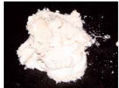
白石綿(クリソタイル)
