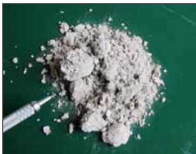
石綿含有岩綿
